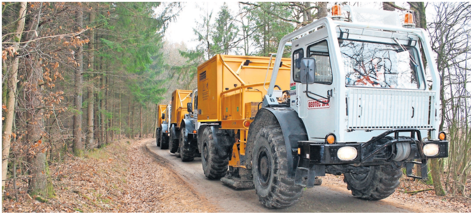
Spezialfahrzeuge senden über Rüttelplatten Schwingungen in die Tiefe.
